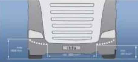
\* Bei Verwendung als Positionslicht muss die Mindestanbauhöhe 350 mm und der maximale Abstand von außen 400 mm betragen.
